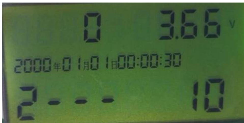
第 5 个页面：显示 RS485 传感器类型、电池电压、信号值、时间
