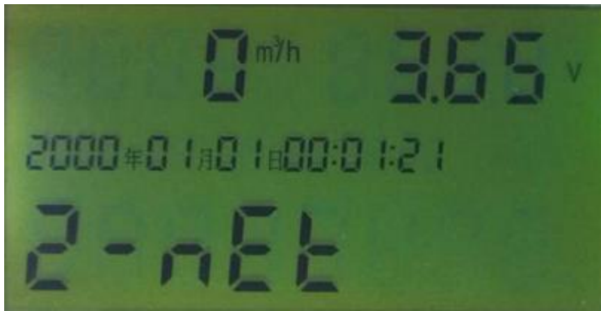
第 14 个页面：显示 GPRS 附着、电池电压、瞬时流量、时间
