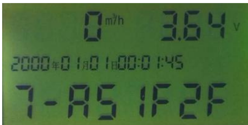
第 18 个页面：显示连接状态、电池电压、瞬时流量、时间
