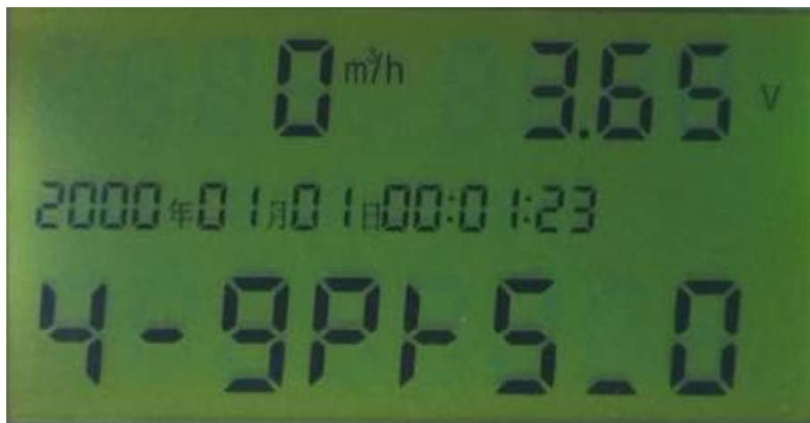
第 16 个页面：显示 PPP 拨号、电池电压、瞬时流量、时间
