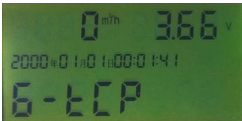
第 18 个页面：显示连接状态、电池电压、瞬时流量、时间
