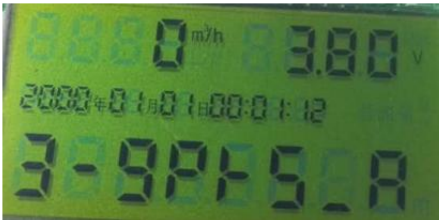
第 15 个页面：显示 GPRS 拨号、电池电压、瞬时流量、时间
