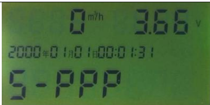
第 17 个页面：显示 TCP 连接、电池电压、瞬时流量、时间
